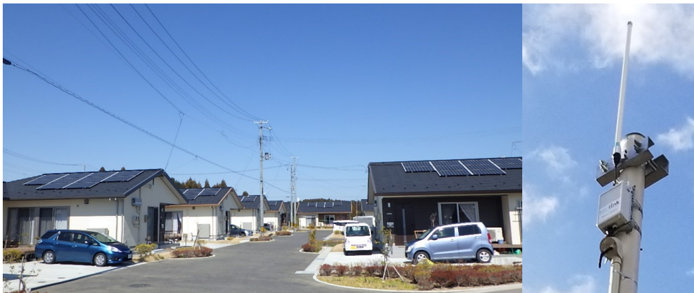
スマートコミュニティのまち並み (写真右:LoRaWAN ゲートウェイ・ポール高さ 8m)
